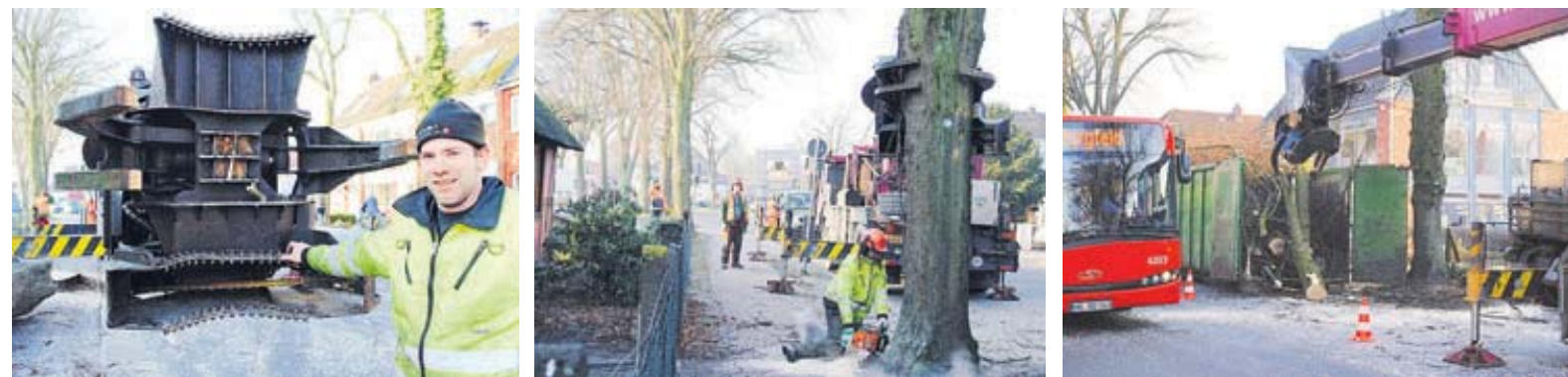
Der sogenannte Vollernter (Foto links) arbeitet sich am Baum von oben nach unten vor. Dort kommt dann die Kreissäge zum Einsatz (Mitte), bevor die einzelnen Teile in einen Container verladen werden.
