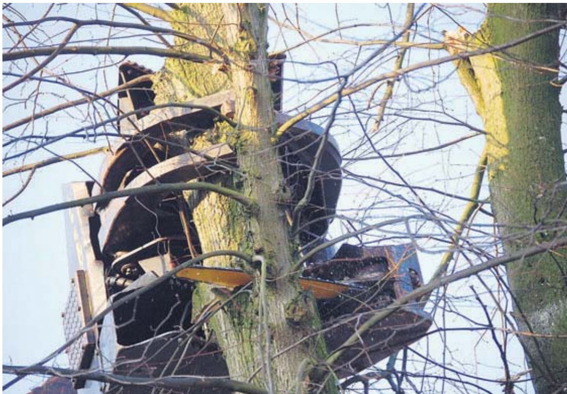
Wenn der Hydraulikarm einmal zugefasst hat, gibt es kein Entrinnen mehr. Die integrierte Säge erledigt den Rest.
